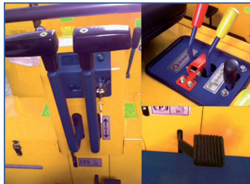
1 EINFACHES LENKSYSTEM 2 DREH-/KIPPHEBEL 3 FESTSTELLBREMSE
