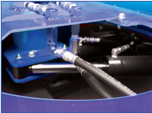
DREHFUNKTION: ANSTEUERUNG DES DREHKRANZES ÜBER ZWEI HYDRAULIKZYLINDER
